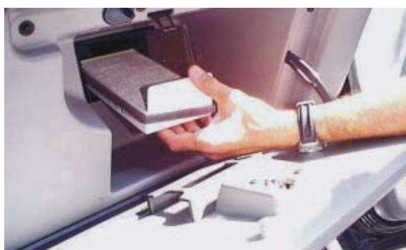
(PL) Ostrożnie usunąć zabrudzone filtry, wymienić na nowe i wykonać powyższe czynności w kolejności odwrotnej
